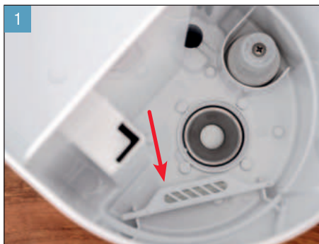
Vložte A7017 Ionic Silver Stick®.
